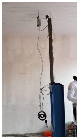
Figura 10 – Aplicação da carga de ensaio e medição dos deslocamentos
