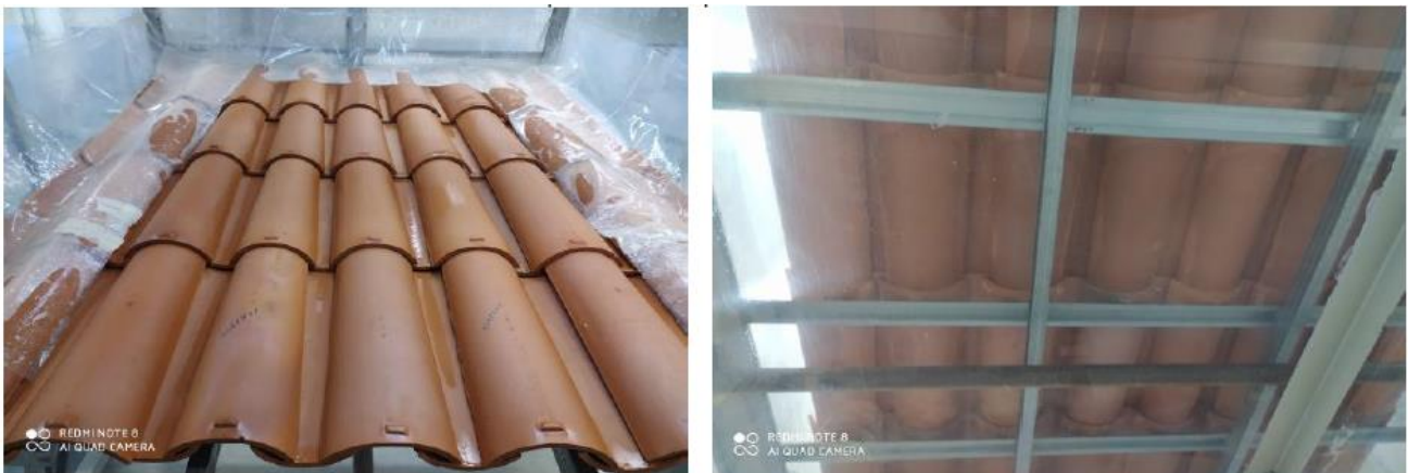
Figura 7 – Face superior e inferior do painel de telhas após o ensaio (Fonte: Relatório 00619-21 – CCB)
