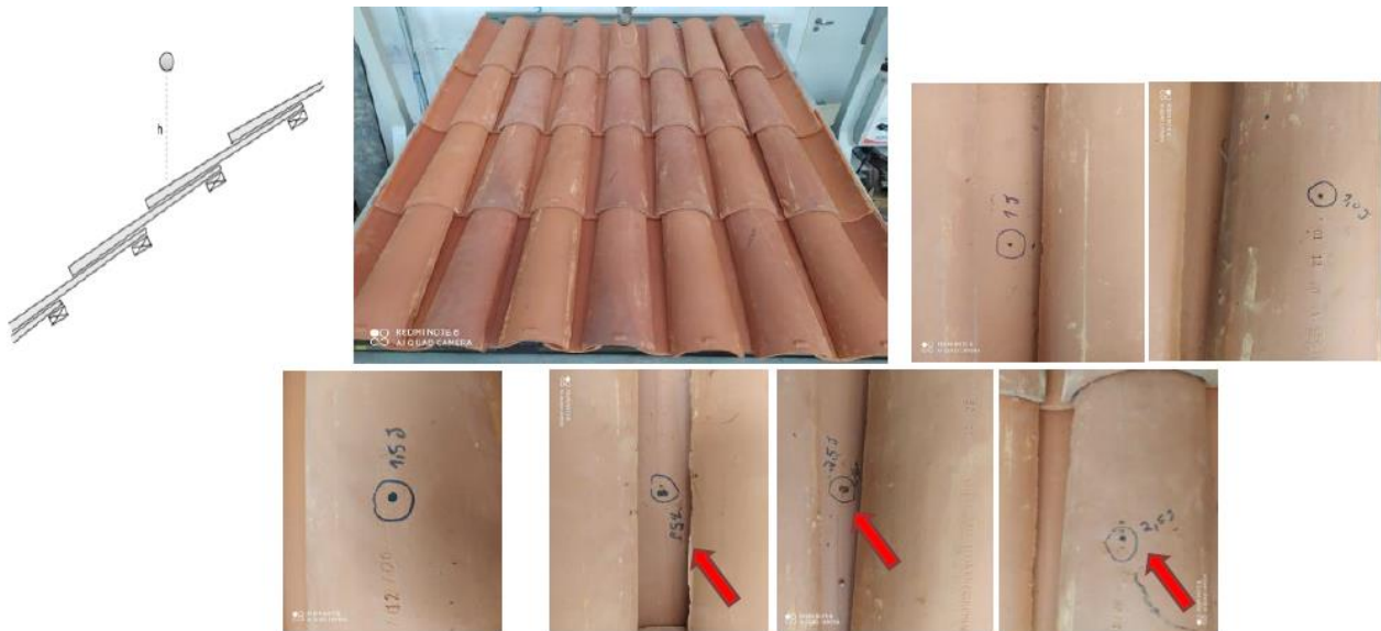
Figura 3 -Telhas após impacto de 1J, 1,5J e 2,5J (Fonte: Relatório de ensaio 00619 21 rev 01 – CCB)
