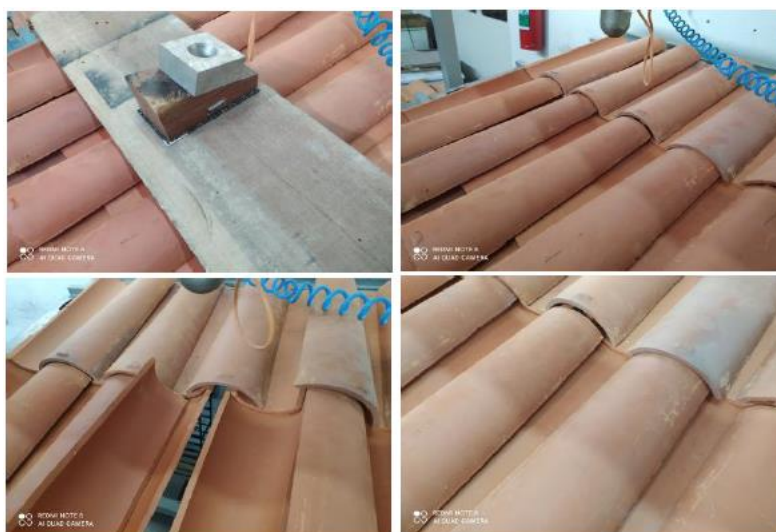
Figura 6 - Realização do ensaio de resistência ao caminhamento (Fonte: Relatório de ensaio 04269 21 - CCB)
