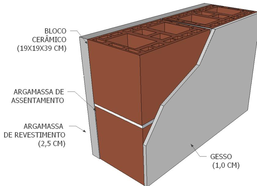
As Tabelas 1 e 2 apresentam as características dos principais componentes: blocos cerâmicos, argamassa de assentamento e de revestimento, obtidas por meio da realização de ensaios em laboratório. O revestimento de gesso deve estar conforme as normas técnicas ABNT NBR 13867 e ABNT NBR 16618.
