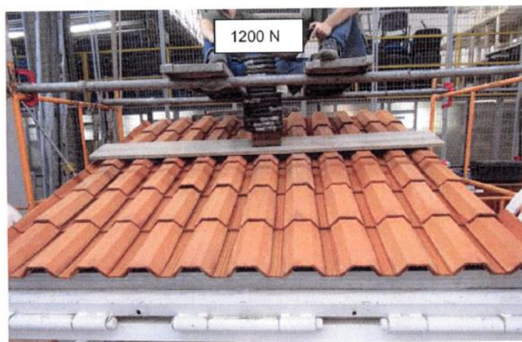
Figura 15 - Realização do ensaio de caminhamento
