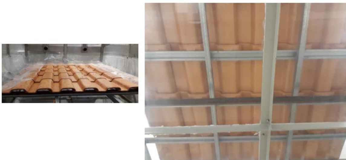
Figura 12 – Face superior e inferior do painel de telhas após o ensaio
