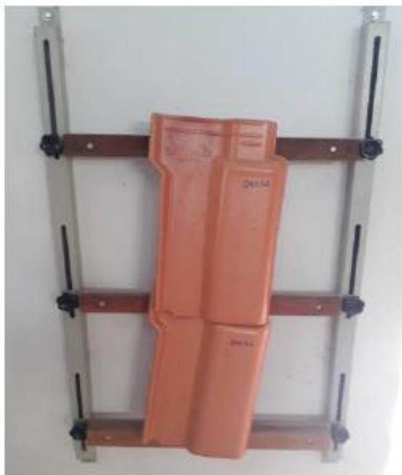
Figura 10 – Execução do ensaio de fixação de garra
