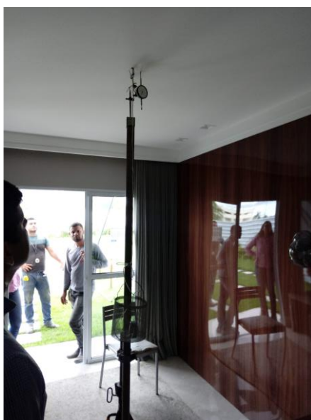
Figura 7 - Realização do ensaio de resistência de peças fixadas em forro de gesso acartonado
