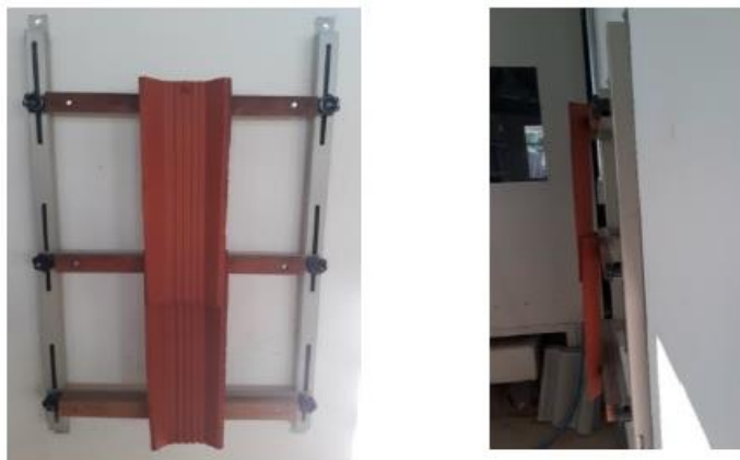
Figura 15 - Instrumentação requerida ao ensaio de fixação de garra
