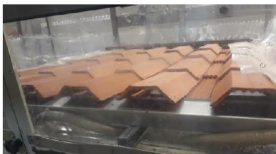
Figura 18 – Execução de ensaio de estanqueidade à água
