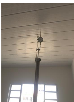
Figura 13 – Realização do ensaio de resistência de peças suspensas em forro de PVC
