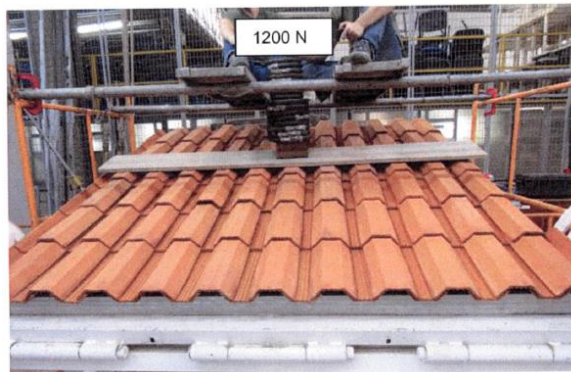
Figura 17 - Realização do ensaio de caminhamento
