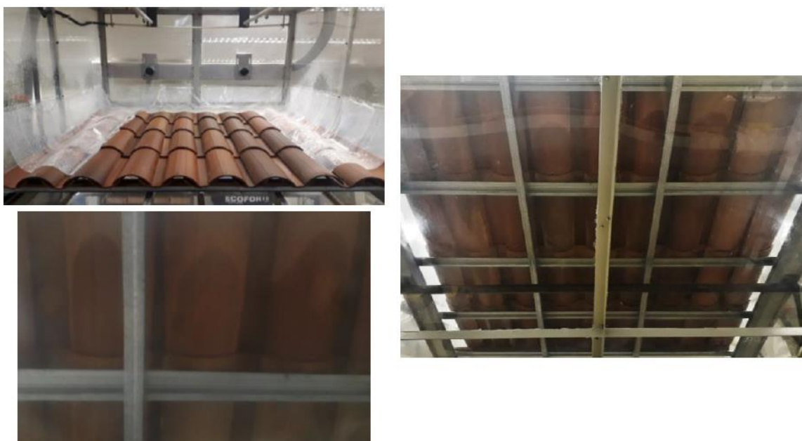
Figura 15 – Execução de ensaio de estanqueidade à água
