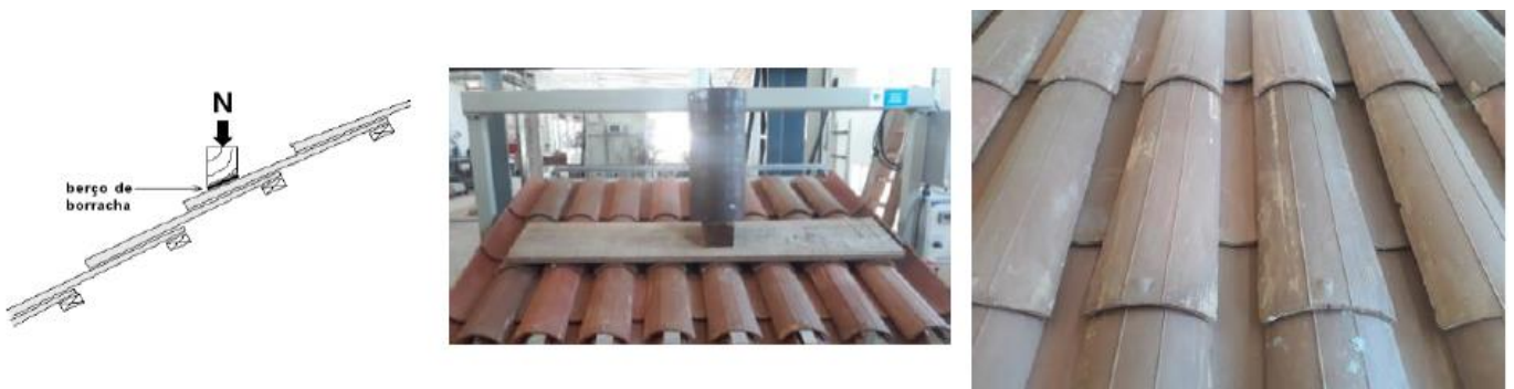
Figura 14 - Realização do ensaio de caminhamento
