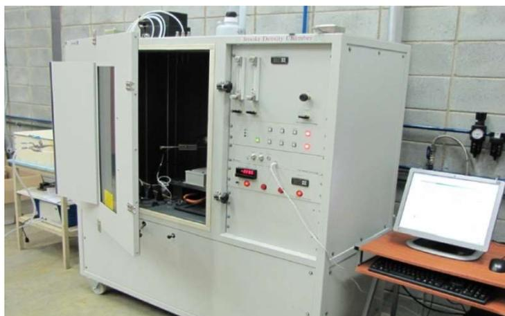
**Figura 22 – Câmara e ensaio de densidade óptica de fumaça**
