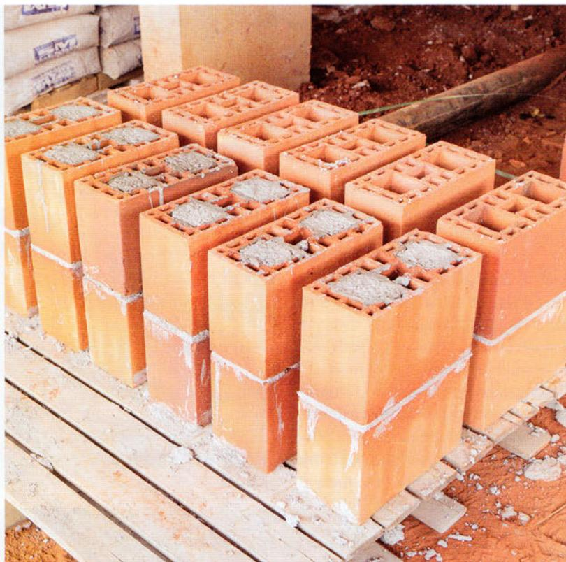
O empreendimento da construtora Vieira & Andrade no interior de São Paulo usa blocos cerâmicos no sistema de alvenaria estrutural
