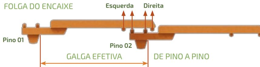
A galga serve para determinar a distância de sobreposição entre telhas adjacentes no telhado. O fabricante deve indicar a galga nominal como referência, no entanto, não dispensa a determinação no local.
